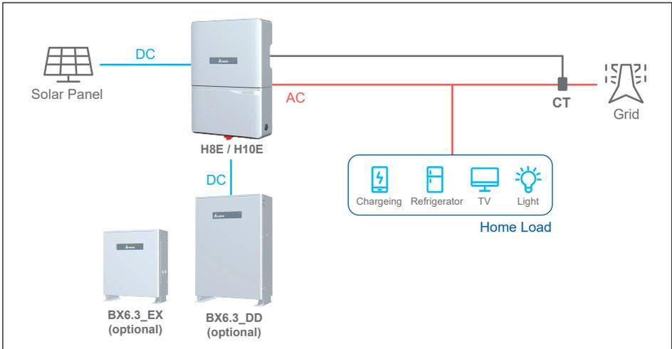
**Figure 1-1 : System diagram**
